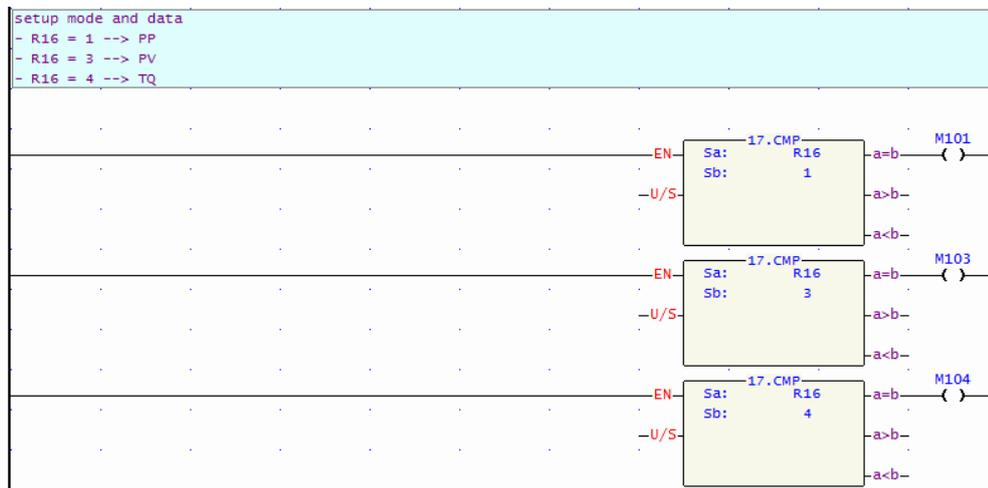
圖 13 階梯圖 - 切換操作模式
