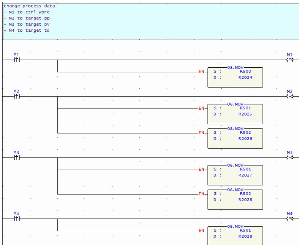
圖 14 階梯圖 - 設定 process data
