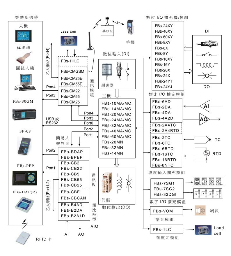
單機系統係指一台主機(一個 CPU)所能掌控之資源(含主機本身及所能擴充之最大 I/O 與通訊),超出單機系統所能掌控之資源就必須藉由通訊連結(LINK)之方式來擴充資源 (請參考下節),下圖爲 FBS-PLC 單機系統資源示意圖,除主機本身之資源外,左側爲通訊 週邊資源,右側則爲擴充 I/O 資源。
