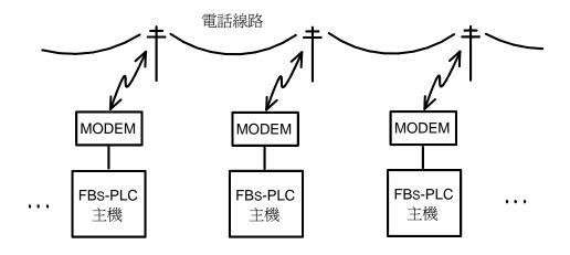
除上述透過區域性網路連結外,FBs-PLC亦可透過 MODEM 經由電話線(可爲專用線或公共撥接電話線路)作遠距離多台 PLC Link(若爲公共撥接電話線路主站 PLC會主動逐一地撥號連結所有僕站 PLC)。
